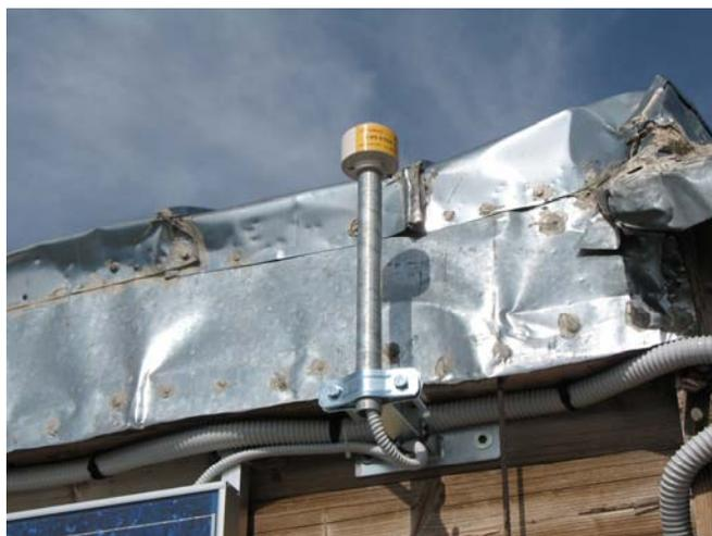
*Sistema GPS installato presso la capanna Carrel*
